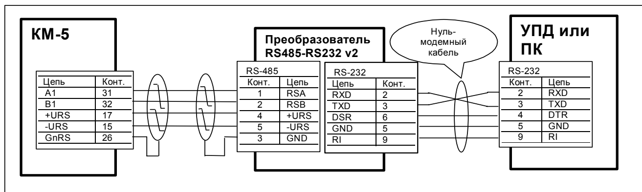
Рисунок п 7.1. Схема монтажа для подключения через преобразователь интерфейса
