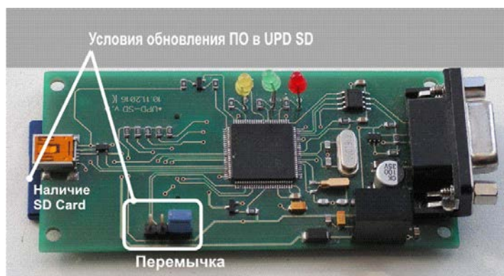
Рисунок В.1 Положение перемычки при смене прошивки в УПД SD
