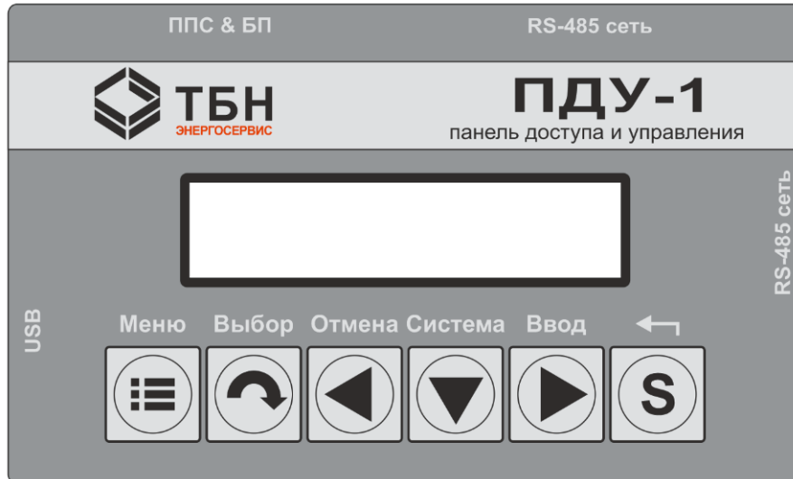
Рисунок Б.1 — Клавиатура и дисплей ПДУ-1
