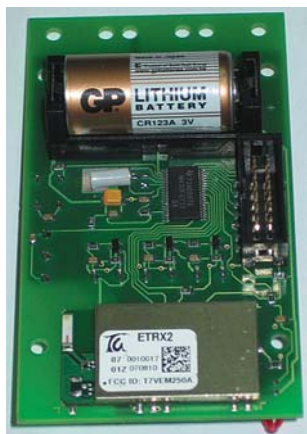
Рис. 4. Квартирный счетчик-регистратор КМ-К-3Z
